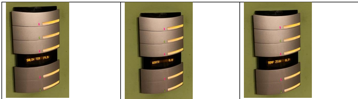
Rys.2. Informacja o temperaturze i wietrze pokazana na wyświetlaczu zadajnika
